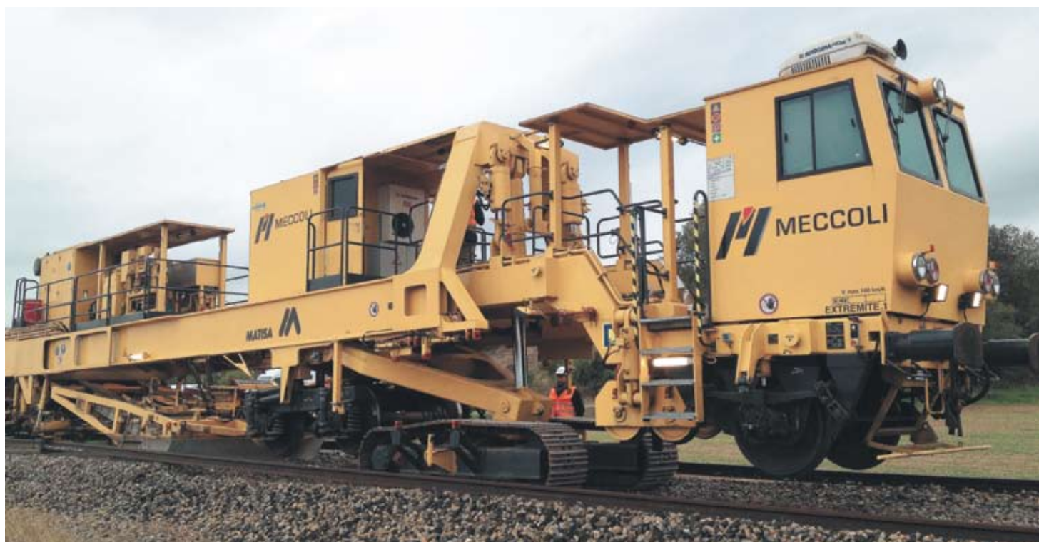
Путеукладочная машина ТСМ 60 входит в состав производственного комплекса для укладки верхнего строения пути раздельным способом
